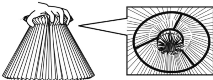
③シェード上面をすぼめて持ったまま、シェード内側の折り返し部分を灯具のフレームに引掛けるように固定します。
